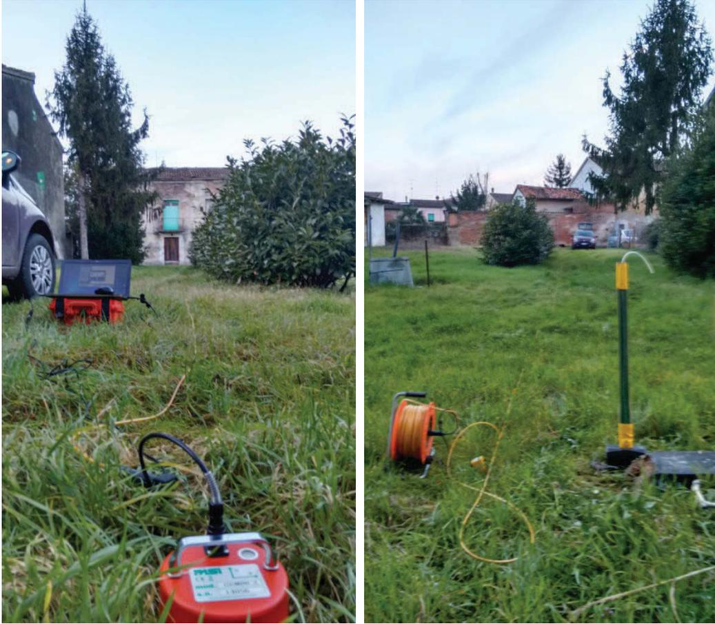
Figura B. 3 - Stendimento sismico MASW realizzato in corrispondenza dell'area di studio.
